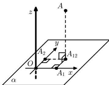
Рис. 7.25. Последовательное проектирование на плоскость и оси
